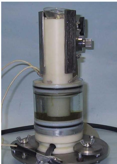
Рис. 5 Макет установки для электровзрывного диспергирования частиц руды, с прецизионной регулировкой зазора между электродами.
